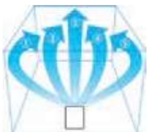
Détection de la pollution par balayage automatique du volet sur 5 positions vers la gauche et la droite. Crée un flux d'air confortable dans la pièce et élimine rapidement la pollution.
